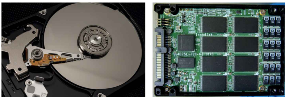
Figura 9. A la izquierda un disco mecánico y a la derecha un disco de estado sólido.
