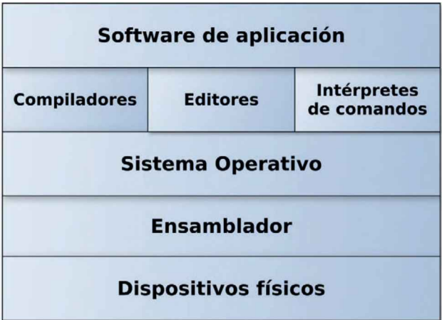
Figura 12. Capas de software. En el primer nivel se encuentran los dispositivos físicos como tales (el software sería el firmware), por encima se encuentra el lenguaje ensamblador, que permite gestionar a los dispositivos físicos. El siguiente nivel es el sistema operativo, el cual actúa de máquina virtual. Las herramientas del sistema operativo se encuentran por encima de este y, finalmente, las aplicaciones o software de aplicación general.
